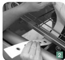
Asegúrese de halar la cinta de fijación firmemente hacia abajo y luego llévela alrededor del marco hacia arriba. Encaje la cinta sobre el vástago del cierre (1), eligiendo un ojal que permita una instalación tensada.
