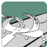
Vérifiez les ceintures avant leur utilisation. Assurez-vous que les coutures ne sont pas endommagées, qu'elles ne sont pas déchirées et que les œillets ne sont pas abîmés. Des produits endommagés peuvent limiter le fonctionnement et causer des blessures. N'utilisez aucun produit présentant des détériorations.
